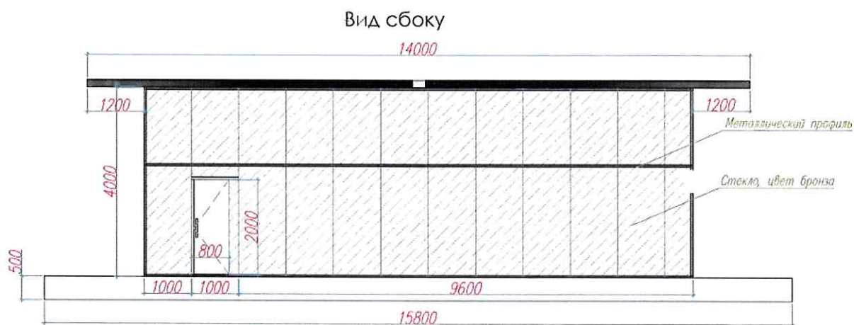
Рис. 23 – Размерный чертеж Павильона края (проекция "Вид сбоку")
